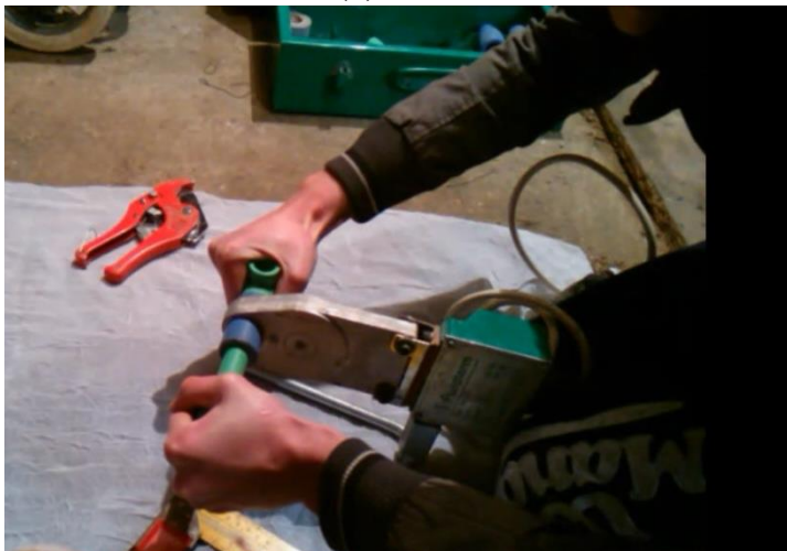
Slika br. 3 (c) Ocrtavanje i provjeravanje dimenzija PVC cijevi; d) Postupak zagrijavanja dva dijela na mašini sa određenim vremenom po tabeli
